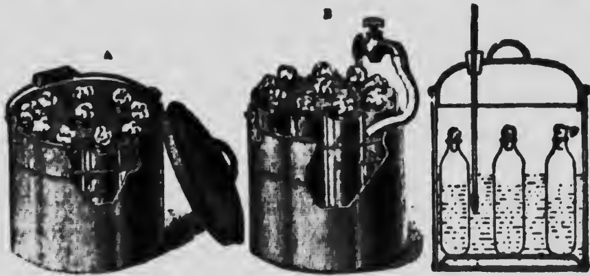
Fig. 13.—Pasteurisateur Freeman. On indique en B comment se servir du robinet de l'aqueduc pour refroidir l'appareil et le lait qu'il contient, immédiatement après la pasteurisation accomplie.
